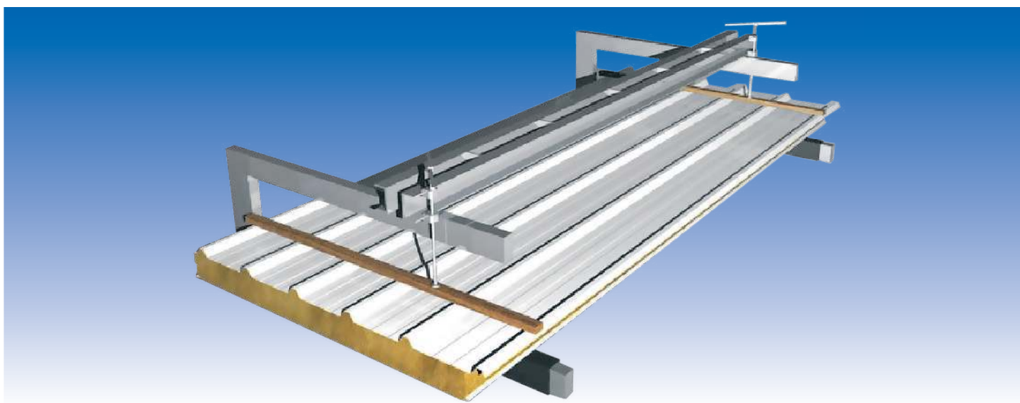
Рисунок 14: траверса для перемещения кровельных панелей
